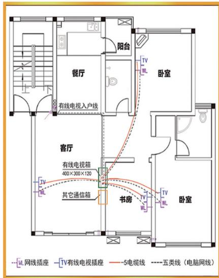
1. 有线数字电视箱安装在原布线位置,规格建议不小于400mmx300mmx120mm,并预留220V电源插座。
