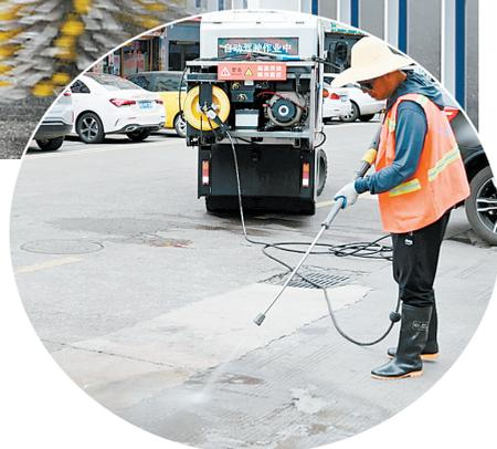
环卫工人用高温高压清洗车清洗地面
