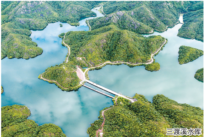
三渡溪水库主坝位于象珠镇郑三村三渡溪自然村。水库集雨面积 15.83 平方千米 ,总库容 1091 万立方米 ,是一座以灌溉为主 ,兼顾防洪、供水、发电等综合利用的中型水库 ,水库灌溉象珠、唐先、东城、西城等镇(街区)计 833.33 公顷农田。
