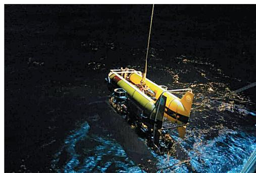
我国自主研发的 海龙11000 无人有缆潜水器日前在西北太平洋海山区完成6000米级大深度试潜,最大潜深5630米,创下我国无人有缆潜水器深潜纪录。
