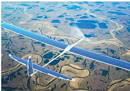
日前,我国自主研发的新型彩虹太阳能无人机已圆满完成临近空间飞行试验,飞行高度达到20000米,共计飞行了15个小时,这标志着我国已成为继美、英之后第三个掌握该技术的国家。这款新型彩虹太阳能无人机,最大的特点就是能将取之不竭的太阳能作为驱动能源,具备超长航时特点,未来留空时间可长达数月至数年。这款无人机是实现情报、侦察、监视和通信中继等功能的超长待机空中平台,可以执行重大自然灾害预警、应急救援救灾等任务。
