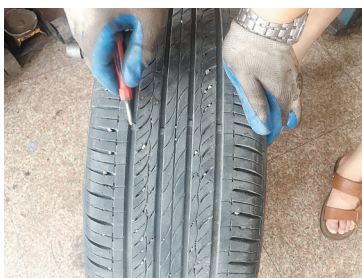
检查轮胎安全槽是否磨平,上高速前清理轮胎上的螺丝、钢钉、石子等杂物
