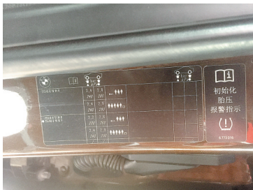
参考汽车自带的标准胎压表给轮胎充气
