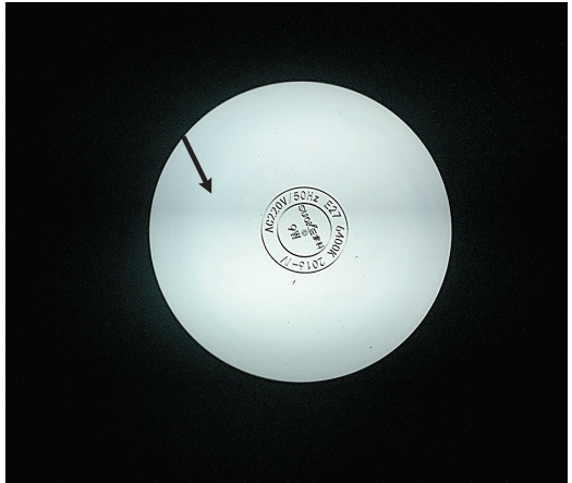
箭头所指处15元LED灯泡在镜头下有频闪现象
