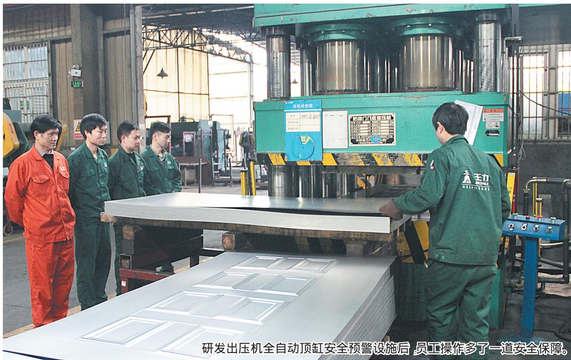
研发出压机全自动顶缸安全预警设施后,员工操作多了一道安全保障。
