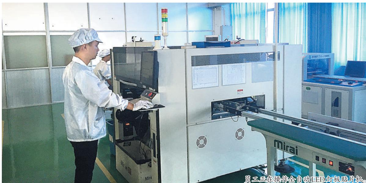
员工正在操作全自动LED灯板贴片机。
