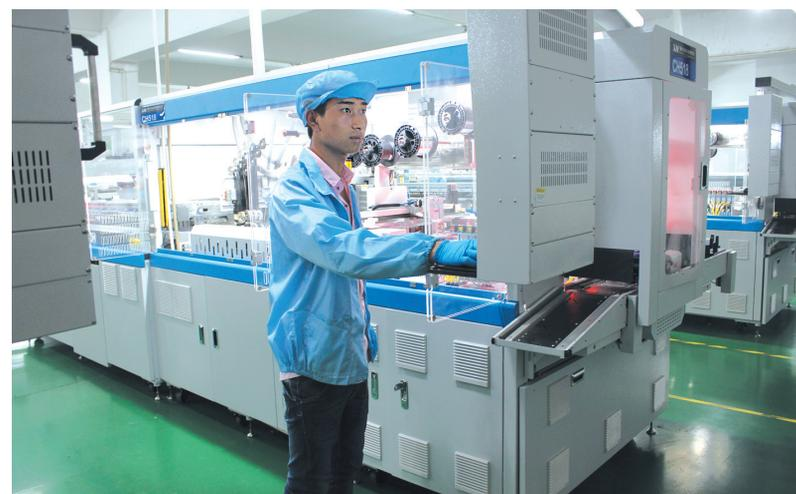
完成吗?面对疑问,李志华满脸自信地笑了。他带记者走进车间,只见几名员工正仔细地将一块块制好的电池板打包,面积为2 $m^2$ 的电池板显得非常轻盈。在员工身旁,全自动单串焊接机正开足马力赶制订单(见上图)。
