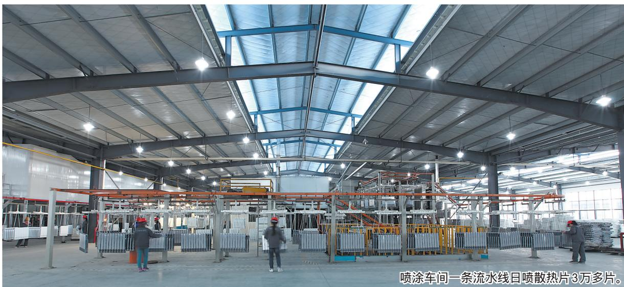
喷涂车间一条流水线日喷散热片3万多片。
