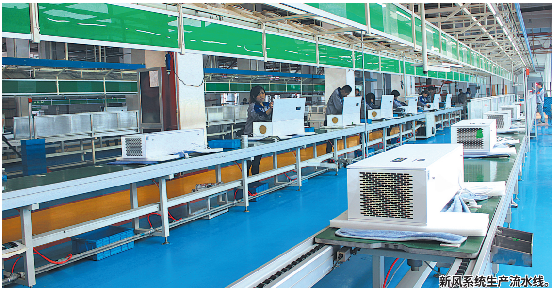
新风系统生产流水线。
