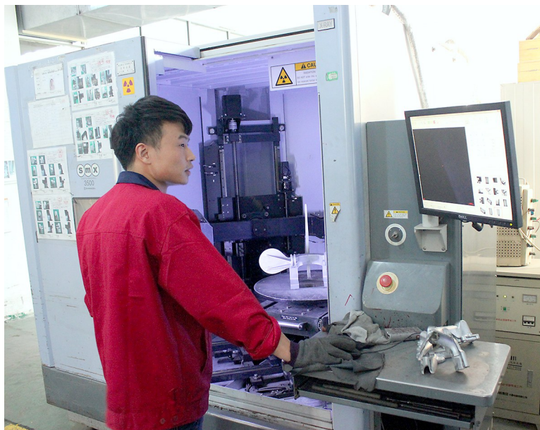
泰龙公司员工演示利用X光对蝴蝶座进行无伤检测。
