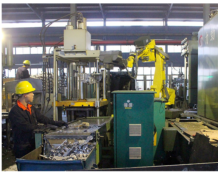
浩天公司机器人压铸岛正在生产发动机配件。
