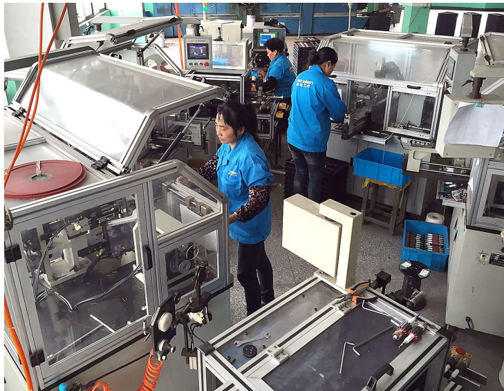
恒稳公司工作人员正在操作全自动转子绕线机。
