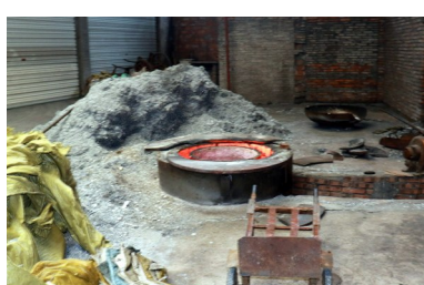
作坊内有5个熔炼炉 ,无环保设施。
