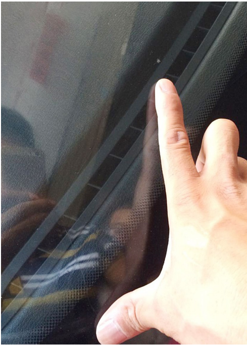
经修复,裂痕消失。
