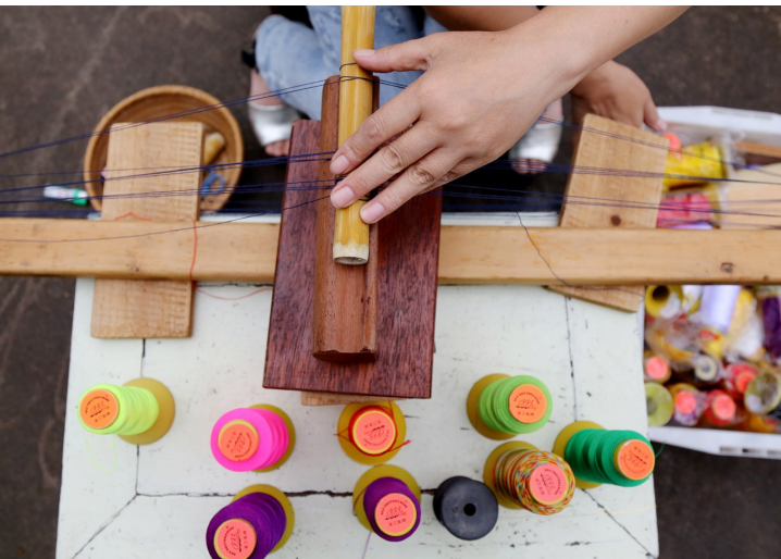
织带工具由带架、带扣、刹板、带梭组成。
